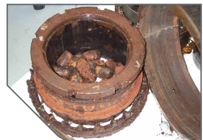
在安装LabTecta®66 之前，这台连续蒸炼器被水污染 (案例编号:3232)
