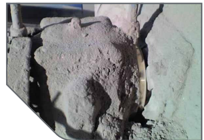
恶劣工况要求固体颗粒防护的情况下，可选择 LabTecta®66OAP (外置空气净化设备)。
