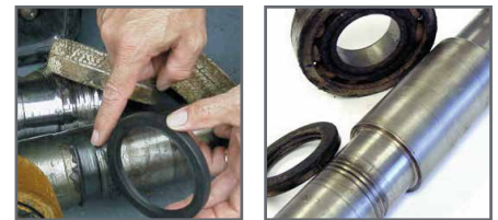
唇封造成的轴磨损 迷宫式密封造成的轴磨损
