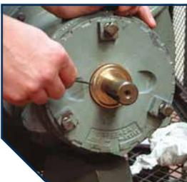
Le LabTecta®66 est réparable sur site, en trois minutes, pour le prix d’un kit de pièces de rechange bon marché. Aucun outil de démontage spécial n’est nécessaire, juste un petit tournevis conventionnel et/ou un outil d’extraction de joint torique.
