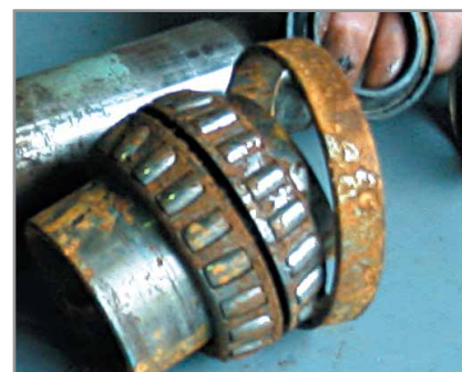
Łożyska zanieczyszczone wilgocią
