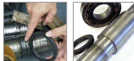
Uszkodzenie wału spowodowane uszczelnieniem wargowym.
