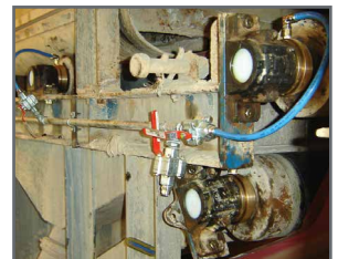
LabTecta-OAP-PB™安装在采矿传送带上
