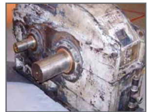
LabTecta® auf einem Falk-Getriebe installiert
