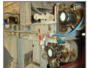
LabTecta-OAP-PB™ auf Förderband im Bergbau montiert
