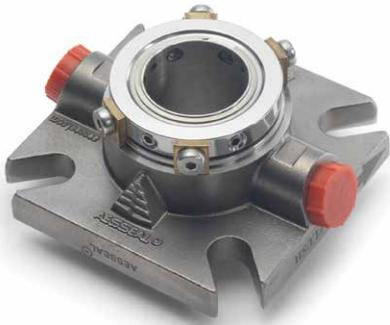
Die DMSF™ wird mit einer integrierten bidirektionalen Pumpring- und Umlenkvorrichtung mit hohem Wirkungsgrad geliefert, die Sperrflüssigkeit zu den kritischen Stellen innerhalb der Dichtung zirkuliert und leitet.
