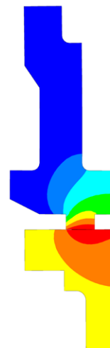
FEA Optimierte Gleitfläche für stabilen Trockenlauf
