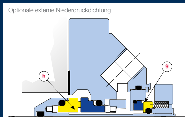
SMSE™ – Stationäre Einzeldichtung mit massiven Flächen und externen (Niederdruck-)Flächen
