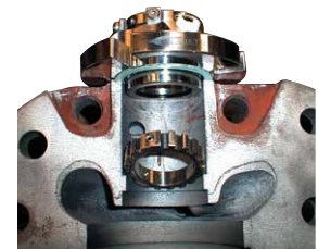
Konventionelle separate Dichtungs- und Pumpingkonfiguration.
