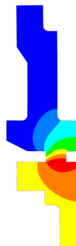
Zoptymalizowana przy użyciu MES powierzchnia uszczelniająca zapewnia stabilną pracę na sucho
