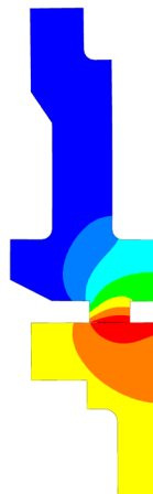
FEM-optimierte Gleitfläche für stabilen Trockenlauf
