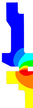
Design delle facce di contatto ottimizzato tramite FEA (Finite Element Analysis) per garantire una rotazione stabile anche con applicazioni a secco
