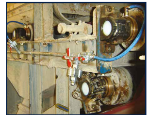
LabTecta-ОАР-РВ™ на конвейере горнодобывающего предприятия
