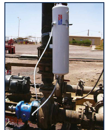
Одно из более чем 70 уплотнений AESSEAL для шлама® и систем SSE-25™, установленных на предприятии SQM Mining, Чили
