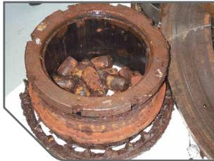
在安装LabTecta®66之前，这台连续蒸发器被水污染 (案例编号:3232)
