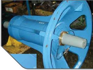
一纸浆厂，在水力碎纸机的变速箱上安装 LabTecta®66TE-OAP(案例号: 3327)
