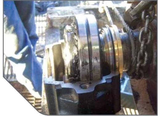
一造纸厂, 安装LabTecta®66PB的SKF轴台 (案例号: 3217)
