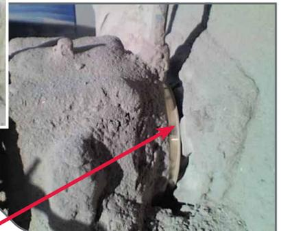
运转三个月以后的LabTecta®66OAP注：空气吹扫将动环和静环接触面的灰尘吹走。
