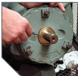
LabTecta®66可进行现场维修，维修过程仅需3分钟和一套价廉的备件包。过程中无需特殊拆解工具，仅需一把常规小螺丝刀和/或一个O形圈取出工具。
