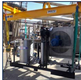
Installation des an einem FDU™- System befestigten FDSC™
