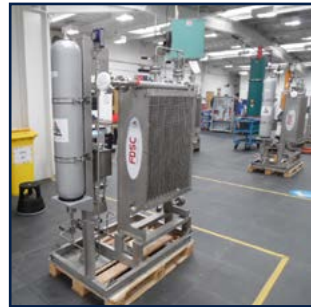
FDSC™-Kühleinheit unterstützt Plan 53B
