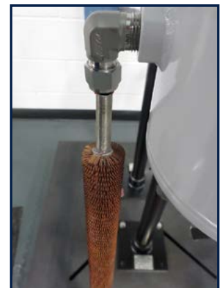
Cupro-Nickel-Finnenrohre auf SP3™-System für Heißenwendungen
