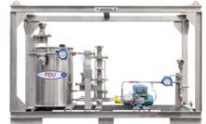
Plan 54 FDU™ ATU Speziell auf die spezifischen Anforderungen des Kunden zugeschnittenes System mit Spülung, Kühlbarriereflüssigkeitszufuhr oder Schmierung
