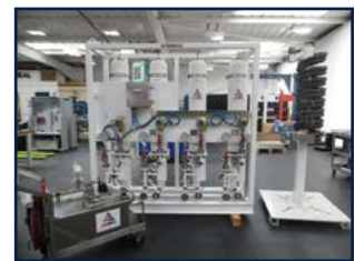
Das komplette Versorgungssystem beinhaltet ein PLAN 53B Multi-Seal-System mit separatem Python-Kühler & Nachfüllwagen
