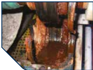
Łożysko ślizgowe dzielone bez uszczelnienia LabTecta®66PB (Nr przypadku 3217)
