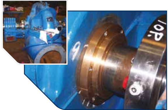
Uszczelnienie LabTecta®66RDS z mocowaniem kołnierzym zamontowane w pompie dwustrumieniowej w 2007 r. (nr przypadku: 3304)
