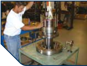
Uszczelnienie mieszarki, której wartość wynosi 50 000 USD, zniszczone w wyniku wnikania wody deszczowej przez uszczelnienie wargowe w cenie 20 dolarów (nr przypadku: 3459)
