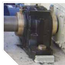
Uszczelnienie LabTecta®66OAP zamontowane w instalacji pyłowej (przed rozruchem) w Argentynie (Nr przypadku: 3220)
