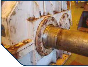
Uszczelnienie MagTecta-FS™ rozwiązało problem ciągłego wycieku z przekładni w Brazylii (nr przypadku: 3494)
