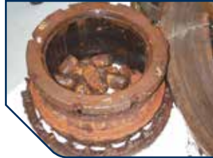
Zanieczyszczenie wodą w warniku ciągłym przed zamontowaniem uszczelnienia LabTecta®66 (nr przypadku: 3232)
