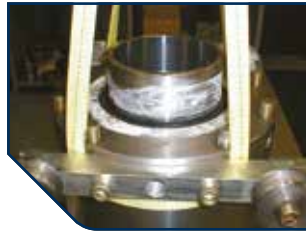
Uszczelnienie mieszarki, której wartość wynosi 50 000 USD, zniszczone w wyniku wnikania wody deszczowej przez uszczelnienie wargowe w cenie 20 dolarów (nr przypadku: 3459)
