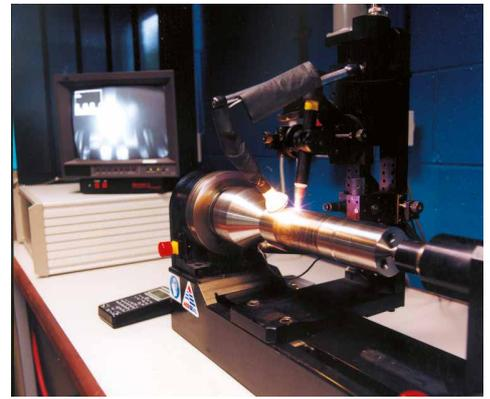
CNC外径波纹管焊接操作
