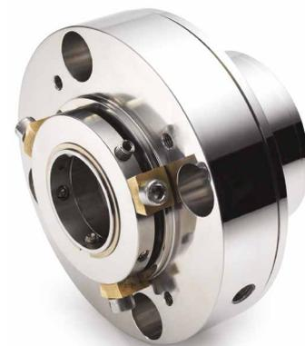
CAPI-74™面对面配置密封：静环设计，双向，平衡型，内置集装式设计Pusher密封及多弹簧设计。这是非接触式泵用双端面密封，用于满足ANSI/API 682 标准，且工作中可实现零排放标准。
