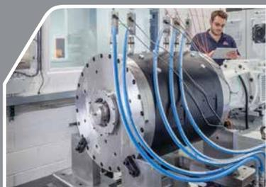
Gasdichtungsprüfstand für große Durchmesser
