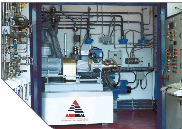
Deux de nos banc-tests pour qualification API
