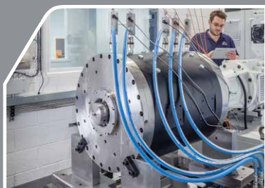
Banco prova per tenute Dry Gas di grande diametro
