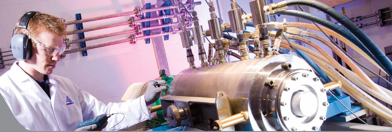
干气压缩机密封测试台
