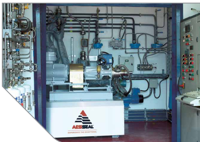
Два стенда для испытаний на соответствие техническим условиям API
